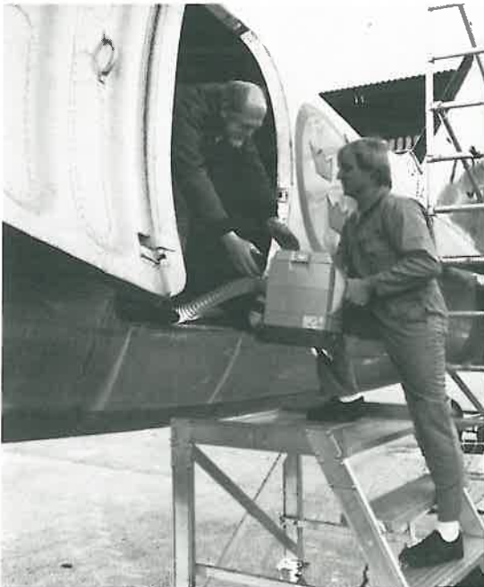
Genom ett avfuktningssystem och luftslangar ventileras hela flygkroppen kontinuerligt med torrluft. Här arbetar Håkan Hedevid och Magnus Karlsson med DC 3-an.
